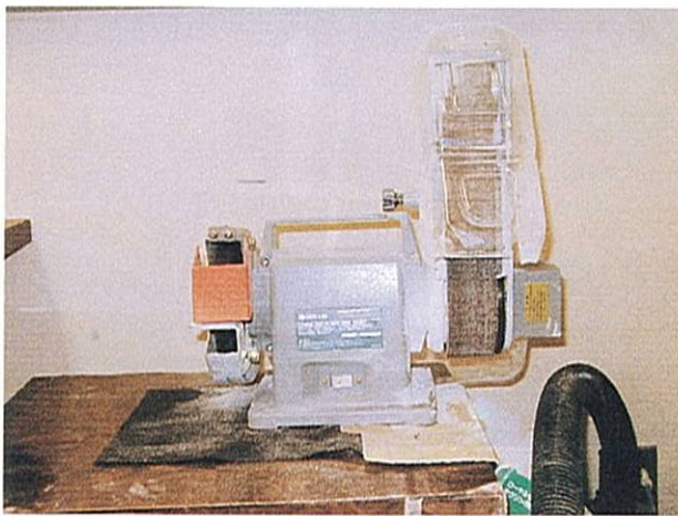
図4：ベルトグラインダー 日立工機 BGM-50 ベルト粒度60~100
