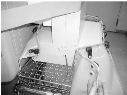
Fig.4 プロテクター有りの生殖腺吸収線量測定の概観
