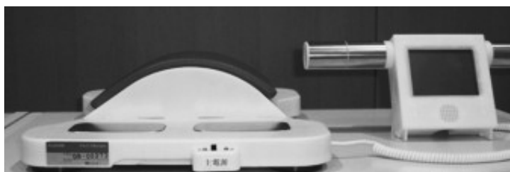
図1 下肢筋力測定・訓練器 円筒部にかかる圧縮力を内蔵された歪みゲージで評価する。
