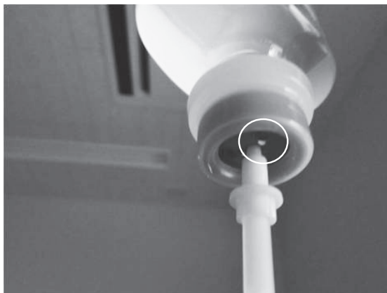
図5 ピン針を刺した際の薬剤を注入した針穴からの漏出 ○の中に薬液の漏出が認められる。
